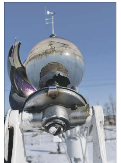
Гелиограф. Прибор для автоматической регистрации продолжительности солнечного сияния в течение дня.
