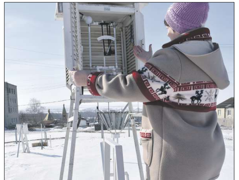
Психрометрическая будка на высоте 2 м от поверхности почвы, в которой расположена психрометрическая пара. Пара термометров «сухой — смоченный» позволяет с высокой точностью измерять влажность воздуха и температуру.
