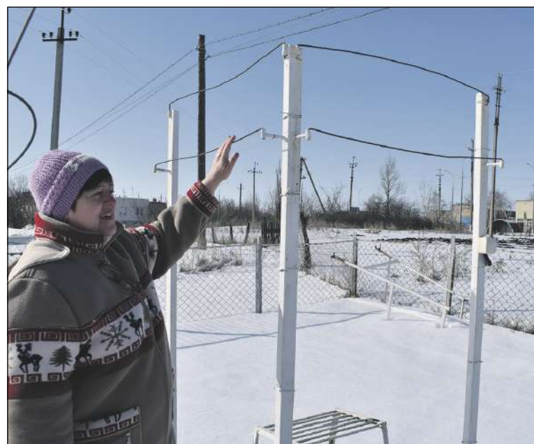
Гололедный станок состоит из 4 проводов — горизонтально-меридианных и широтных. В зимнее время определяют по нему гололедно-изморозевые отложения
